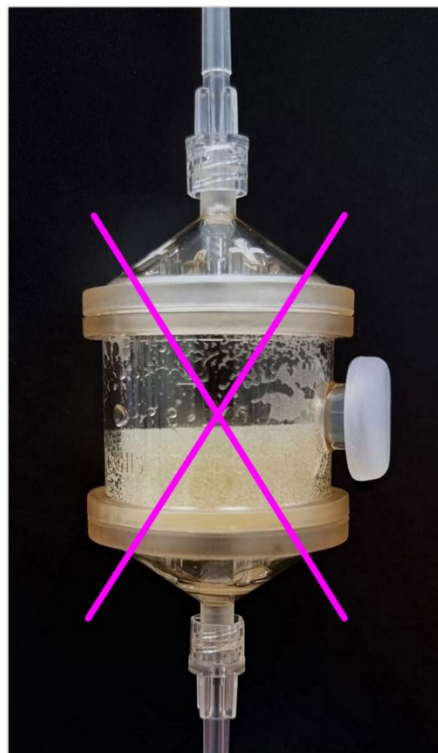
Neprávně - komora s pryskyřicí (tělo) není zcela zaplněna neprůhledným roztokem
